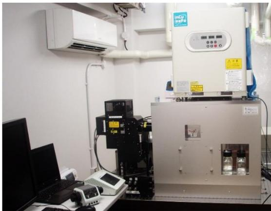
使用する顕微鏡：オリンパス社製 LCV-MPE **インキュベータ型多光子顕微鏡**
